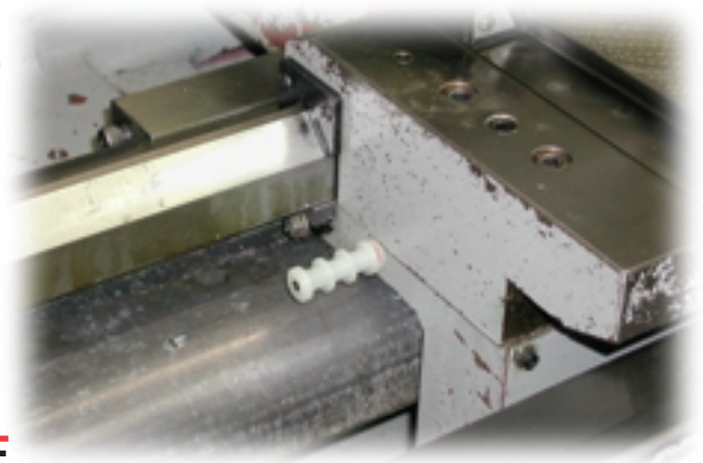
Bilden visar en nödstoppdämpare monterad på en toppslid.
