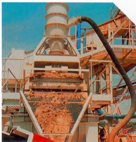
Linatex sandanläggning med Linaplus OZ som slit-skydd i ränna.
