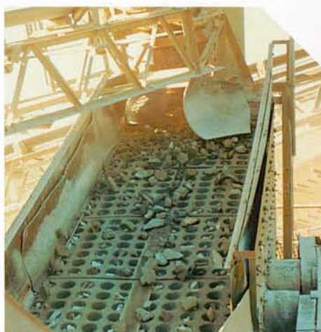
Linard HD som siktduk vid siktning av krossad granit.
